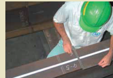
シナイ定規に描かれた記号に従いサシガネで鉄骨に罫書きします。
